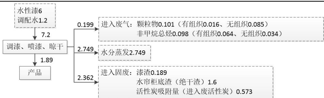
图 2-3 水性漆物料平衡图 (t/a)
